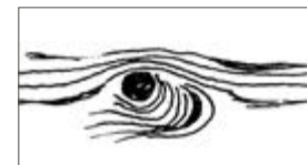
Umwallter, gut ins Stammholz eingewachsener Ast
