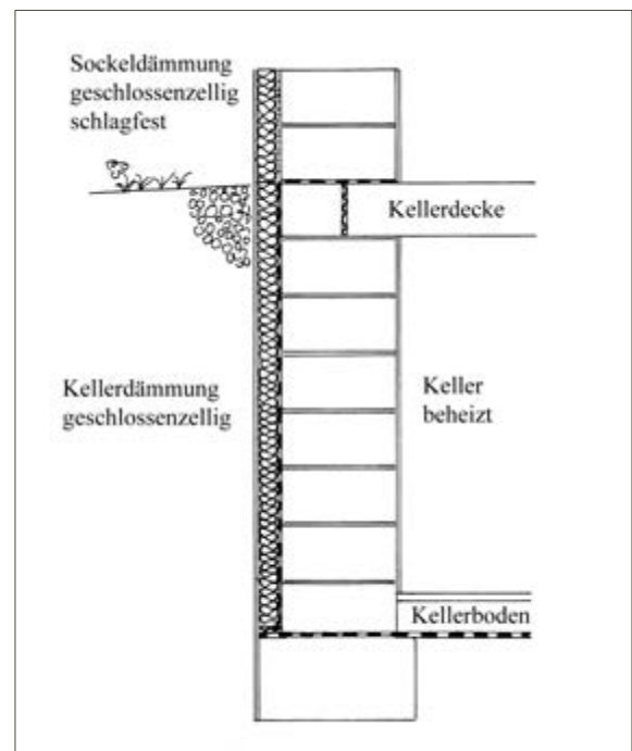
Bei beheizten Kellern wird die Außenwand gedämmt. Das geschlossenzellige Dämmmaterial ist zugleich Schutz gegen Feuchtigkeit aus dem Erdreich.
