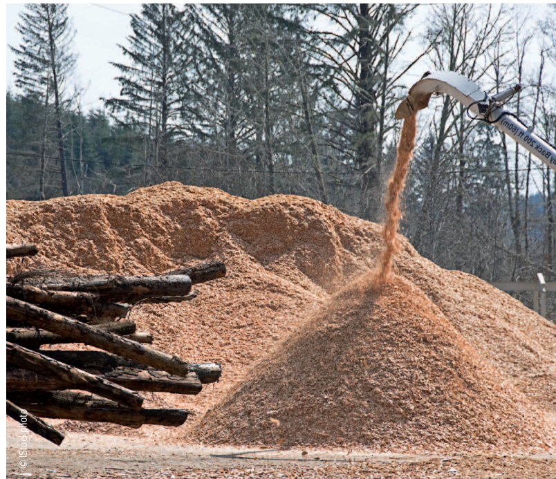
Holzreste für die Dämmung
