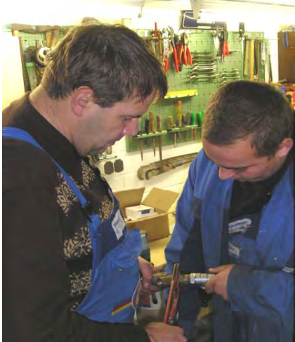
Der Einbau des Schmutzfilters wird in der Werkstatt vorbereitet.
