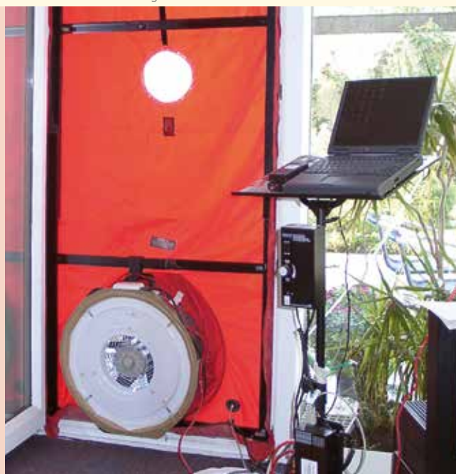
Ventilator zur Durchführung eines Drucktests
