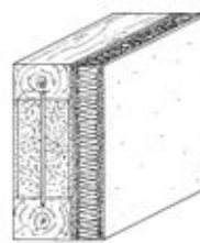
Innendämmung mit Dämmplatte verputzt
