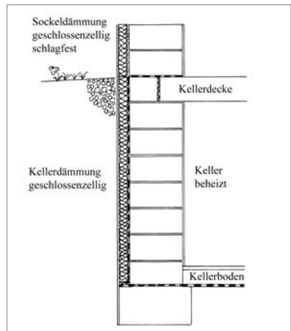
Bei beheizten Kellern wird die Außenwand gedämmt. Das Dämmmaterial ist zugleich Schutz gegen Feuchtigkeit aus angrenzendem Erdreich.
