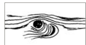
Umwallter, gut ins Stammholz eingewachsener Ast
