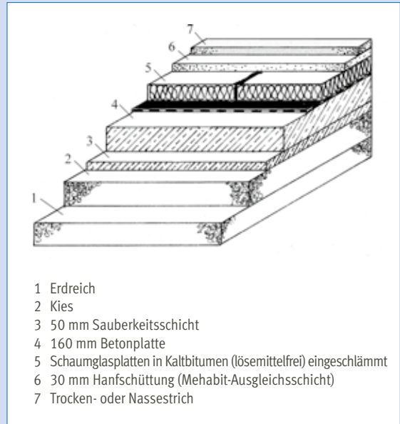
Konventioneller Bodenaufbau auf bestehender Betonplatte als Tragschicht
