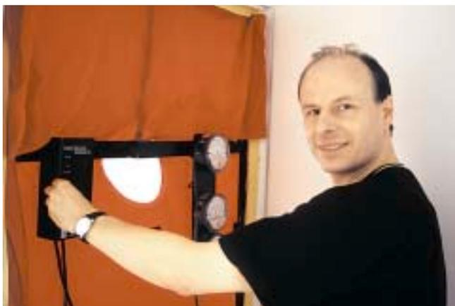
Luftdichtheitstest (Blowerdoor Test) durch Norbert Kochanek, Stadtwerke Hannover AG
