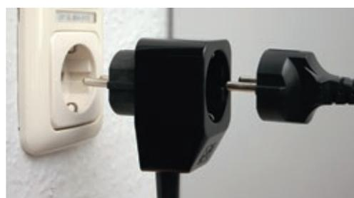
Das Messgerät ist nun in Betrieb. Durch Drücken einer der beiden Pfeiltasten können Sie zwischen drei Anzeigen wechseln. Bevor Sie mit der Messung starten, sollten Sie das Ergebnis der vorherigen Messung löschen! Drücken Sie dazu beide Pfeiltasten gleichzeitig für circa 2 Sekunden.
