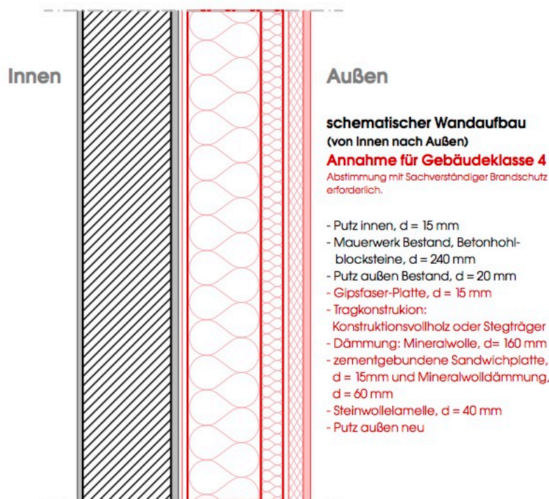
Abb. 18: Wandaufbau für GK 4, ohne Maßstab, bauart Architekten
